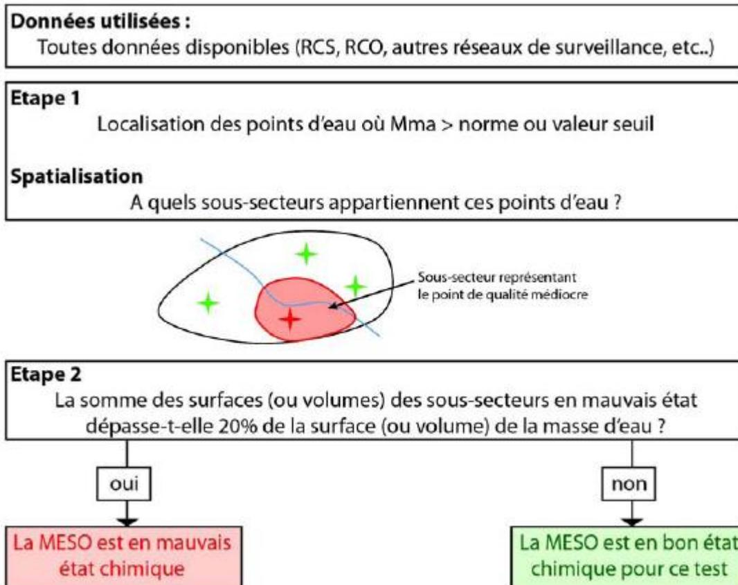
*Illustration 8 : Test qualité générale de la masse d'eau consiste à évaluer la proportion de la masse d'eau en bon état. Il permet de déterminer le bon état ou non de la masse d'eau pour ce test.*
