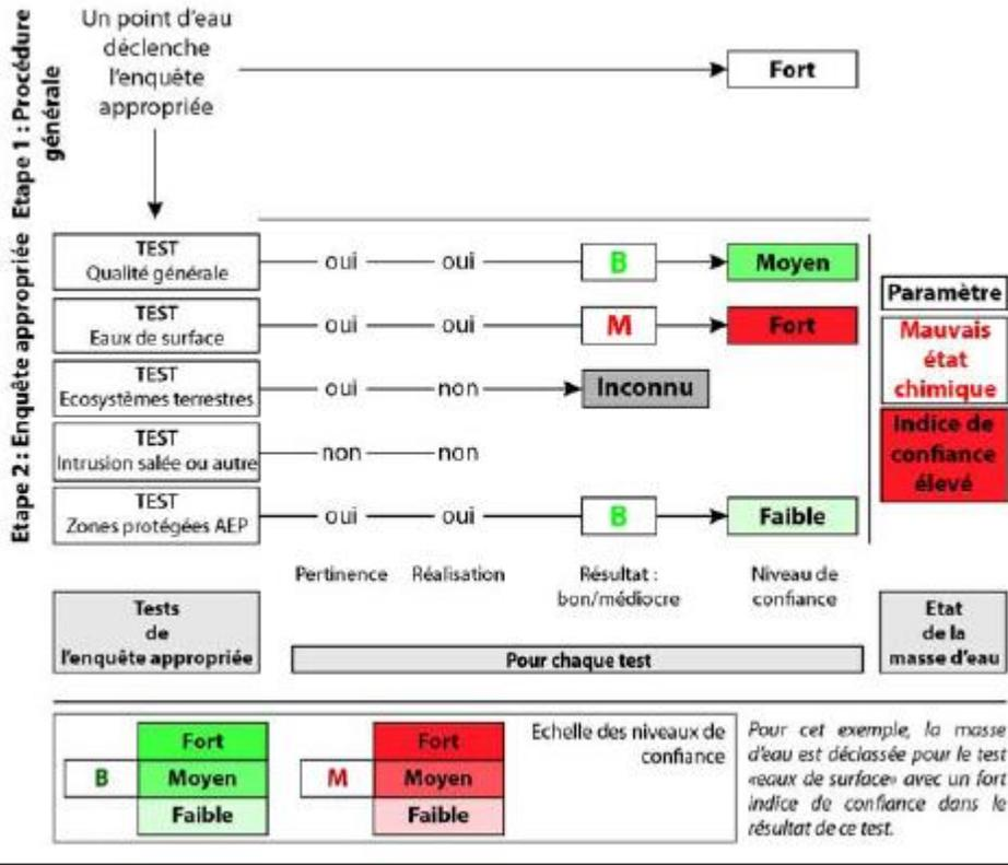
Illustration 21 : Exemple d'indice de confiance global pour une masse d'eau en mauvais état chimique
