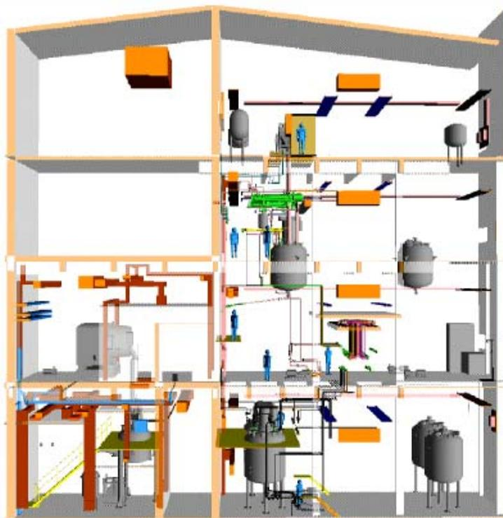
**Figure 2.2 : disposition classique d'une installation polyvalente**
