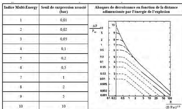
Les courbes d'indice supérieur ou égal à 6 sont confondues pour les niveaux de pression inférieurs à 0,2 bar.
