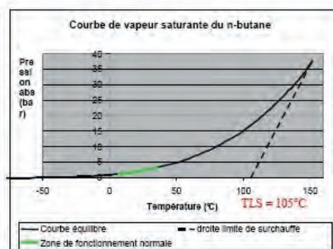
La zone dite de « fonctionnement normal » correspond aux conditions de température et de pression usuellement rencontrées en exploitation. La température de stockage impose la pression dans le réservoir : par exemple, pour le propane stocké à 20°C la pression est de 8,4 bars absolus.
