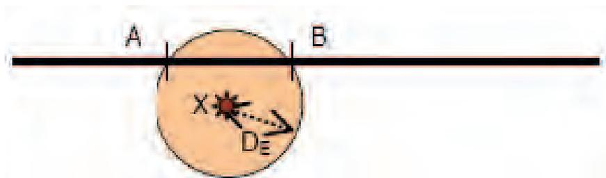
Ce tronçon [AB] de tuyauterie est donc délimité par l'intersection de la sphère centrée au point X considéré et de rayon  $D_E$  = distance d'effet pour l'intensité de l'effet pris en compte ( $D_{Ei}$ ,  $D_{EL}$ ,  $D_{ELS}$ ). Ce tronçon [AB] de tuyauterie mesure donc au maximum  $2D_E$  (soit  $D_E$  de part et d'autre du point s'il est situé sur la tuyauterie).
