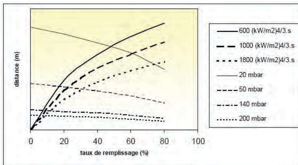
Allure de l'évolution des effets thermiques et de pression lors d'un BLEVE, en fonction du taux de remplissage.
