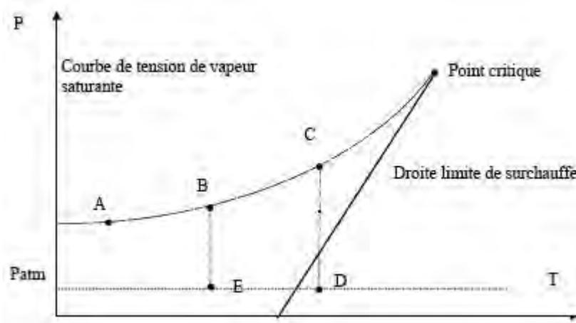
La notion de BLEVE froid ou chaud se réfère uniquement à la température limite de surchauffe (TLS) du produit :
