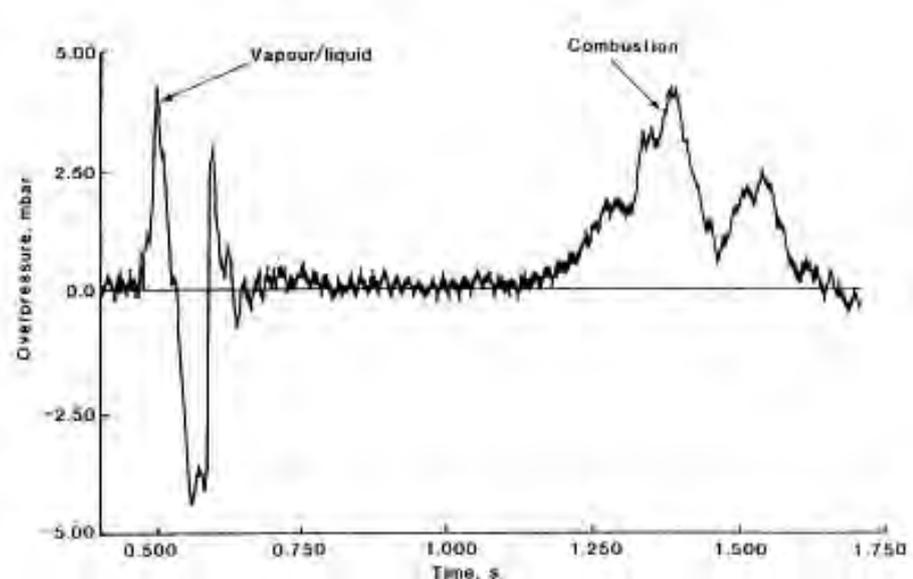
Exemple de signal de pression enregistré lors d'un BLEVE de butane (essai British Gas, d'après S. Shield 1993)
