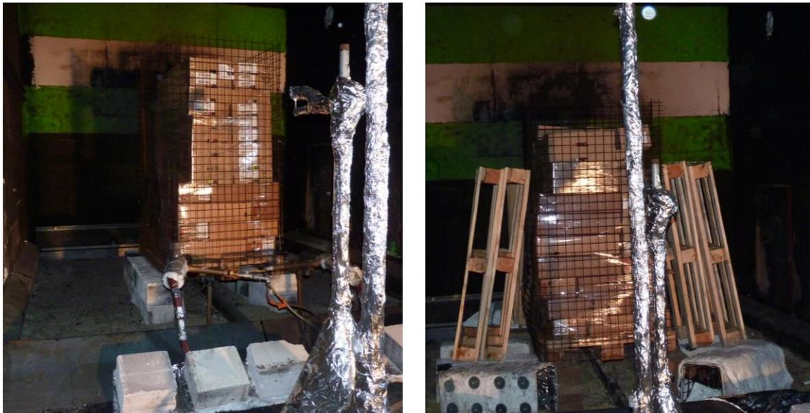
Figure 15 : Photographies des palettes avant les essais, gauche : essai 1, droite : essai 3
