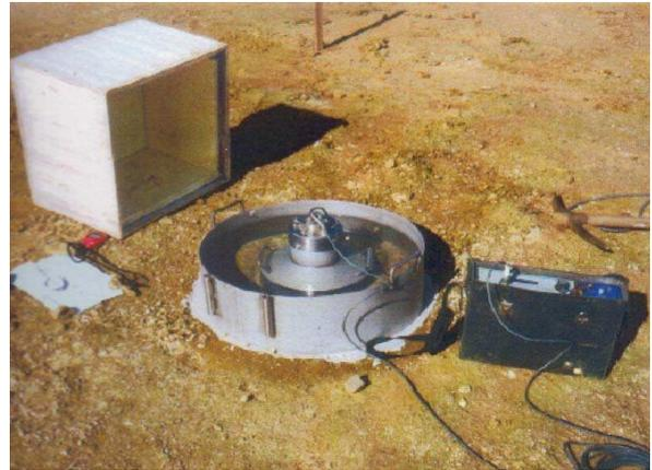
Le principe de la méthode de l'infiltromètre à double anneau repose sur la mesure d'un débit d'eau qui s'infiltré, sous une charge hydraulique donnée, dans un anneau interne, le flux vertical y étant maintenu grâce à un anneau externe, dit de garde, et où règne la même charge hydraulique.
