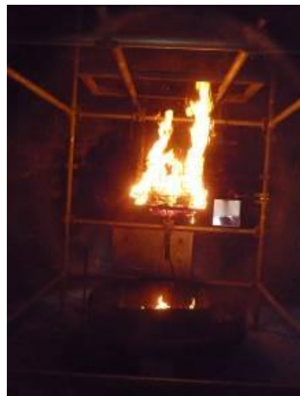
Figure 7 : Photographies pendant la phase d'incendie propagé.
