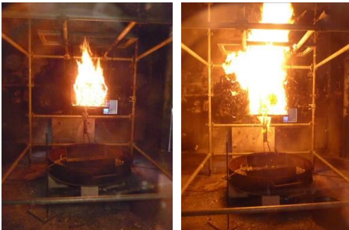
Figure 6 : Photographies pendant la phase d'inflammation (gauche) et éclatement des premiers contenants (droite).
