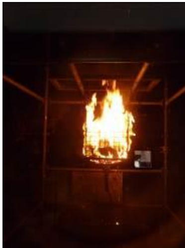
Figure 6 : Photographies pendant la phase d'inflammation.
