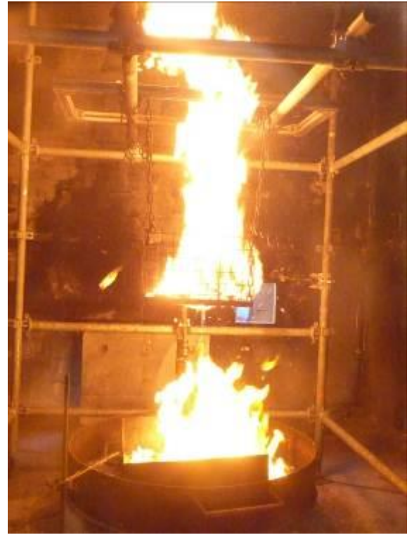
Figure 7 : Photographies pendant la phase d'incendie propagé avec feu de nappe dans la rétention.
