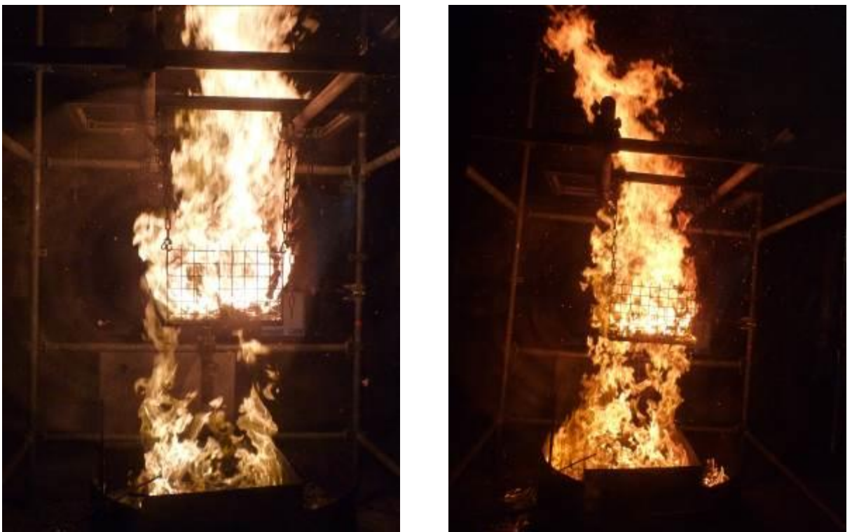
Figure 7 : Photographies pendant la phase d'incendie propagé avec feu de nappe dans la rétention.
