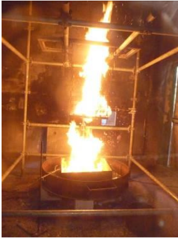
Figure 7 : Photographies pendant la phase d'incendie propagé avec feu de nappe dans la rétention.
