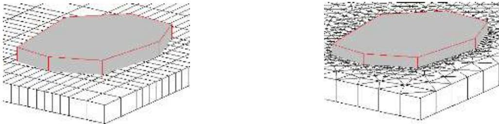
Figure 27 : Exemple de maillages structuré et non-structuré.
