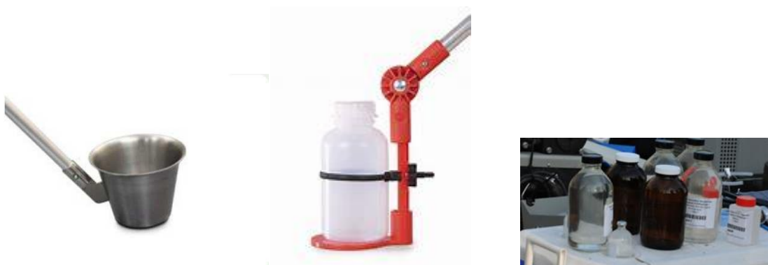
Figure 2 : A gauche canne de prélèvement en inox, au centre canne de prélèvement en polyéthylène et à droite flaconnage en verre (blanc, ambré) et en polyéthylène selon les substances recherchées.
