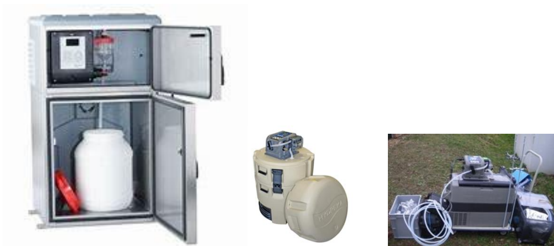
Figure 1 : Exemple d'échantillonneurs automatiques réfrigérés : à gauche une illustration d'un échantillonneur fixe pour l'autosurveillance classique (macro-polluants et métaux), à droite deux échantillonneurs portatifs.
