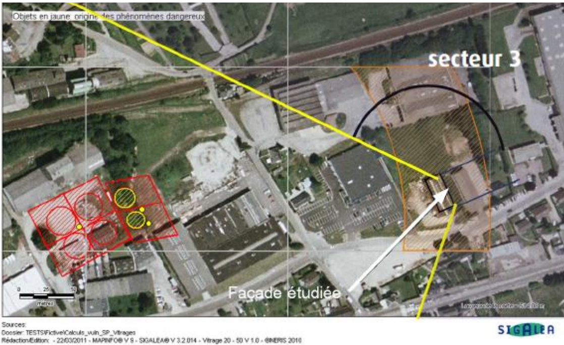
Figure 25 : Exemple – détermination du secteur 3
