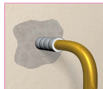
Colmatage sur gaine et joint
