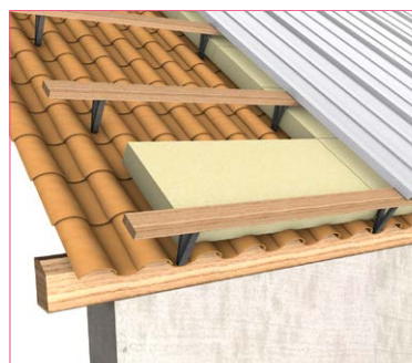
Isolation extérieure par sur-couverture
