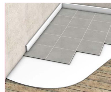
Pose d'un revêtement de sol dur
