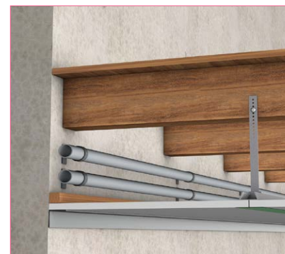
Plafond avec plenum
