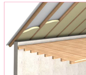
Isolant en sous face de la couverture
