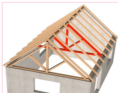
Charpente traditionnelle : Ajout d'une ferme
