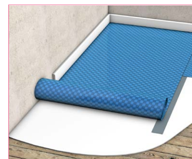
Pose d'un revêtement souple
