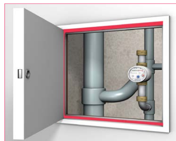
Pose de joints périphériques
