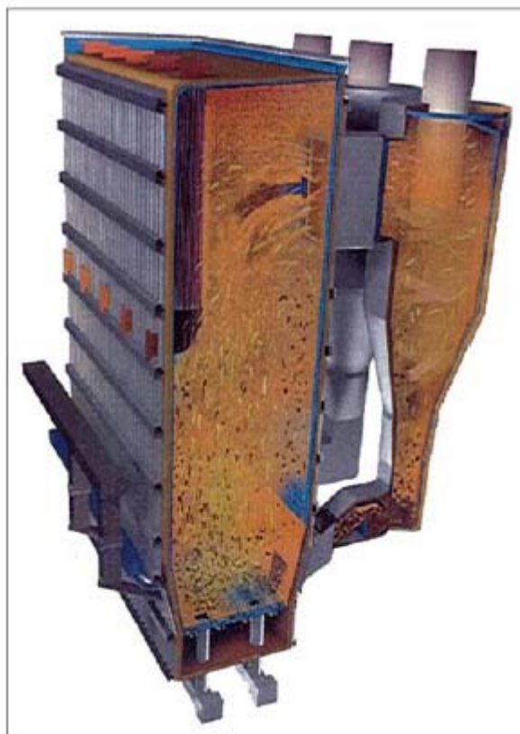
Figure 5.7 : écoulement du combustible et de la matière du lit dans une chaudière CFBC à biomasse [91, Kokk, et al., 2000]
