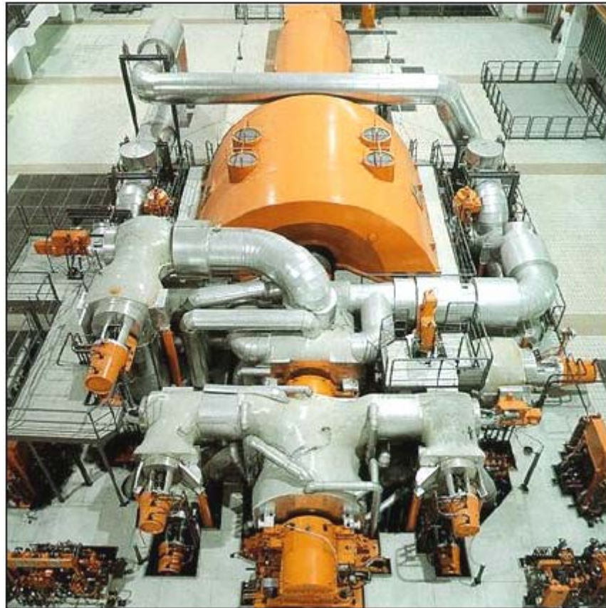
Figure 2.1 : turbine à vapeur moderne d'une centrale électrique au charbon [165, NWS, 2001]
