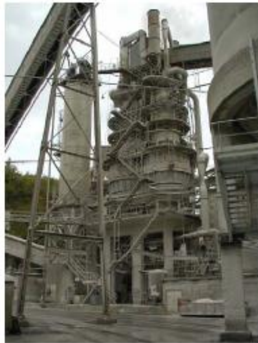
Figure 2.23 : Exemple de four vertical à cycles alternés [44, EuLA, 2006]
