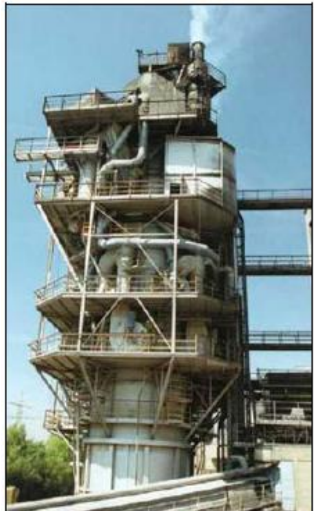
Figure 2.26 : Exemple de four vertical annulaire utilisé dans la fabrication de la chaux [44, EuLA, 2006]
