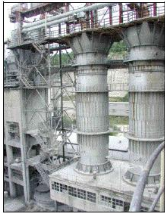
Figure 2.21 : Four vertical à alimentation mixte [44, EuLA, 2006]
