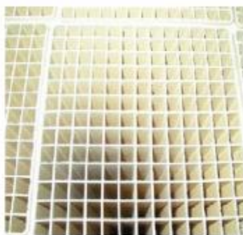
Figure 1.67 : Exemple de catalyseur individuel utilisé dans la technique SCR [140, Italie, 2007]
