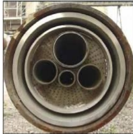
Figure 1.11 : Exemple de brûleur multicanaux [107, Belgique, 2006]
