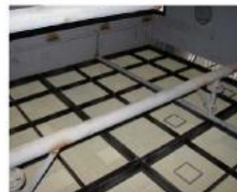
Figure 1.68 : Exemple de position d'un module dans l'unité de SCR [140, Italie, 2007]
