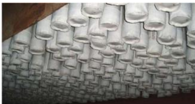
Figure 1.60 : Exemple de filtre à manches et de matière filtrante utilisés dans une cimenterie du Royaume-Uni [82, CEMEX Rugby, Royaume-Uni, 2006]
