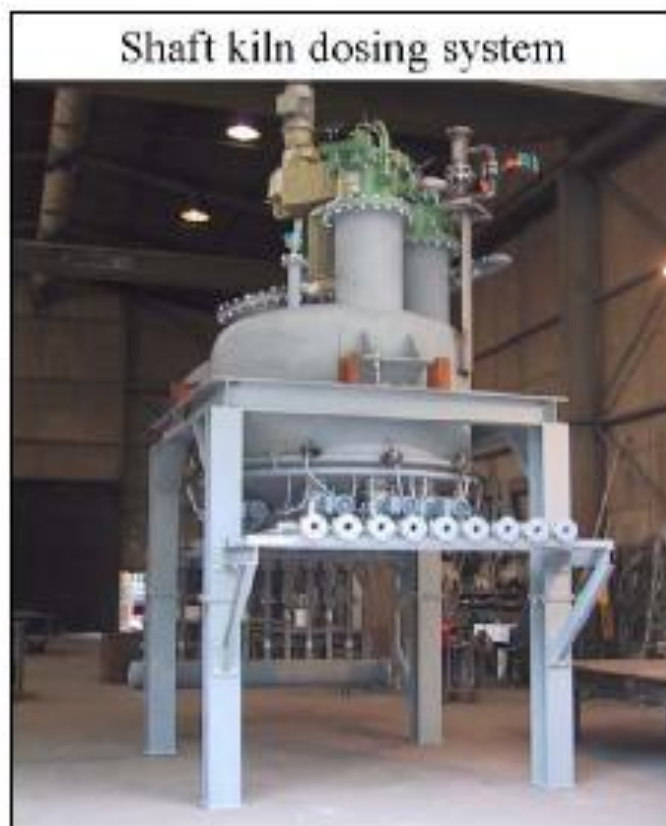
Figure 2.11 : Exemple de système de dosage pour four vertical [44, EuLA, 2006]
