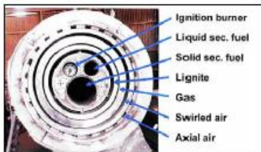
Figure 2.14 : Vue de face d'un brûleur multicanaux dans un four rotatif (RK) [50, Allemagne, 2006], [51, EuLA, 2006]
