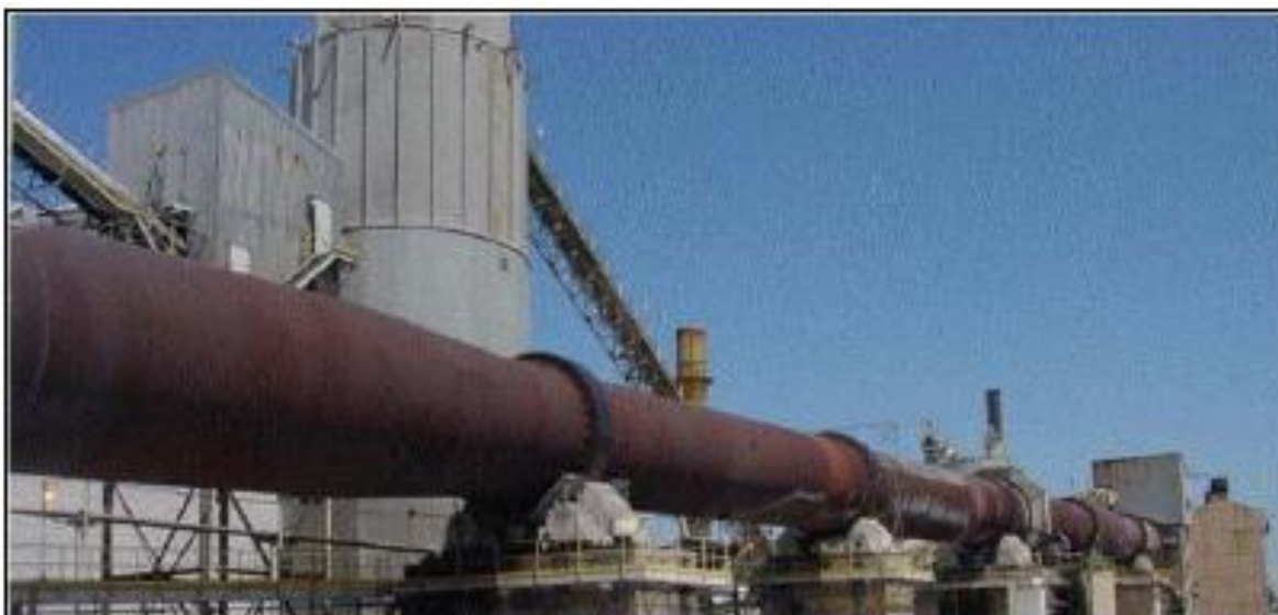
Figure 2.31 : Exemple de four long rotatif utilisé dans la fabrication de la chaux [44, EuLA, 2006]
