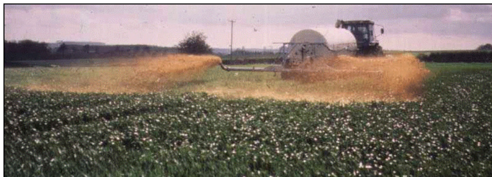
Figure 2.39 : Technique pour répandre à la volée avec une faible trajectoire et une faible pression [220, Royaume-Uni, 2002]
