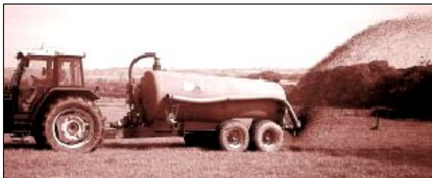
Figure 2.36 : Épandeur rotatif avec un bec disperseur [51, MAFF, 1999]
