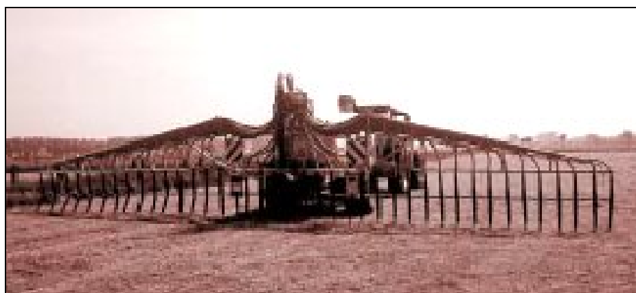
Figure 2.40 : Épandeur en bandes doté d'un distributeur rotatif pour améliorer la distribution latérale [51, MAFF, 1999]
