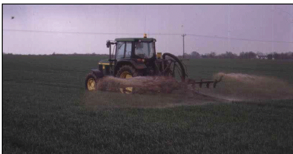
Figure 2.38 : Technique pour répandre à la volée avec une faible trajectoire et une faible pression [220, Royaume-Uni, 2002]
