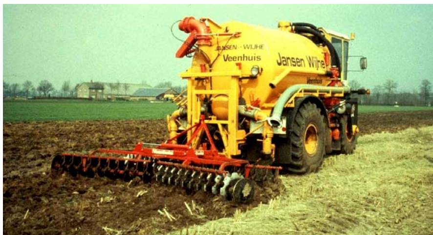
Figure 2.43 : Matériel d'incorporation combiné à un gros réservoir [197, Pays-Bas, 2002]
