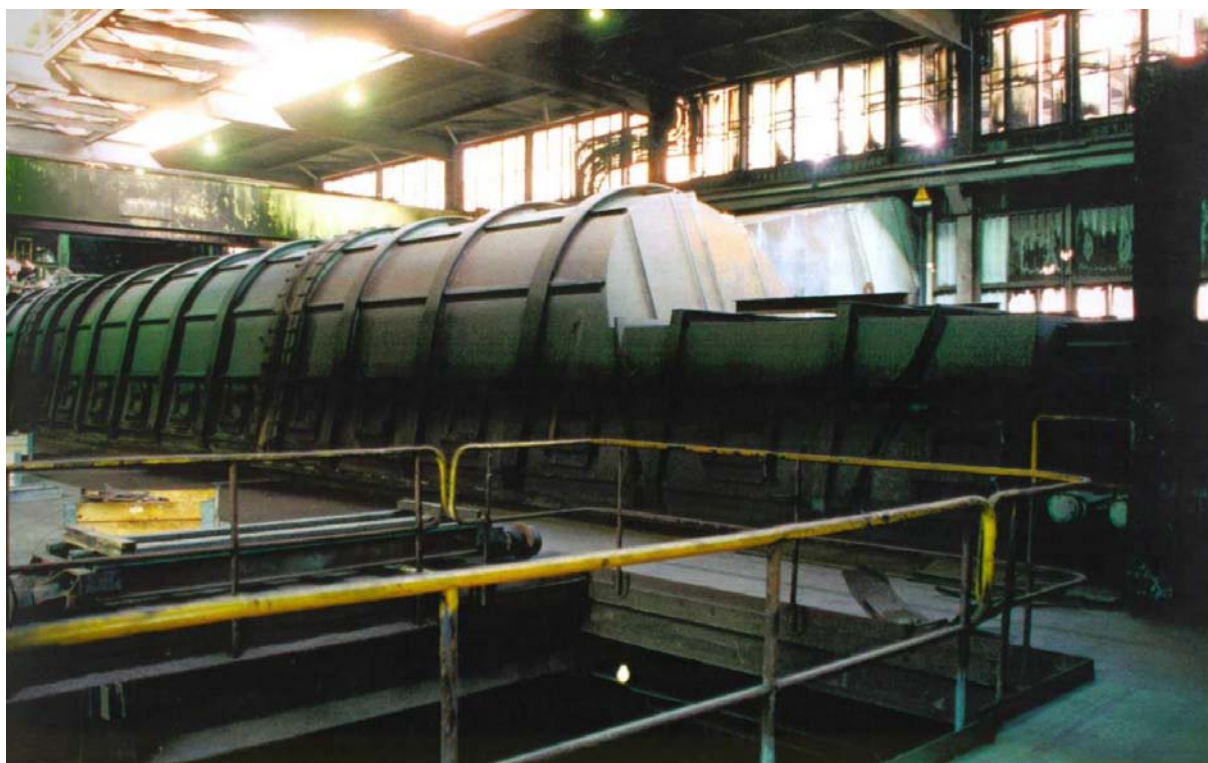
Figure 4.16 : Bande d'agglomération entièrement recouverte, conformément au procédé EOS – [Panne, 1997]
