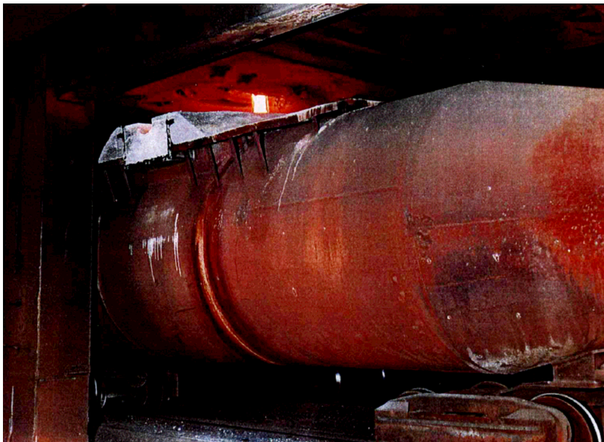
Figure 7.12 : Enfournement de fonte liquide dans la poche tonneau avec la suppression de poussière par gaz inerte – [Haas, 1997].
