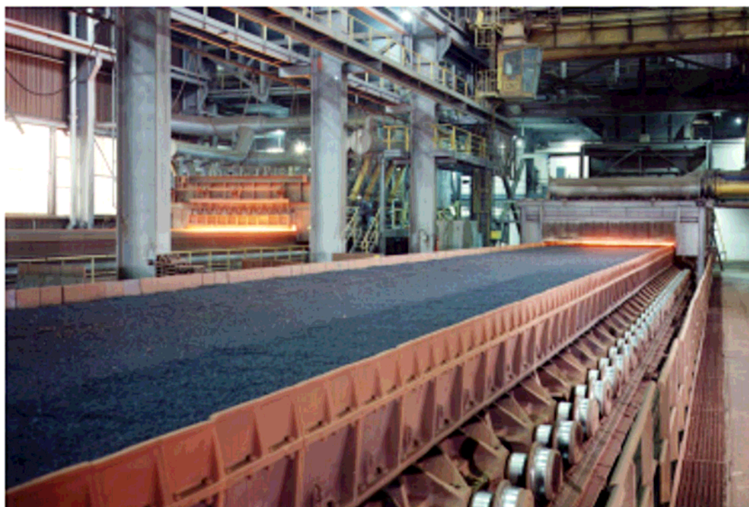
Figure 4.1 : Photographie d'une bande d'agglomération avec l'installation de chargement (tambours ou déverseurs) et le tablier d'allumage en bout de bande
