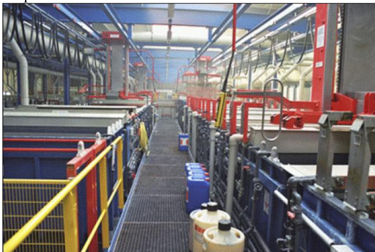
Figure 4.33 : Chaîne de traitement sur support dont les cuves sont dotées de couvercles et d'un système d'extraction d'air
