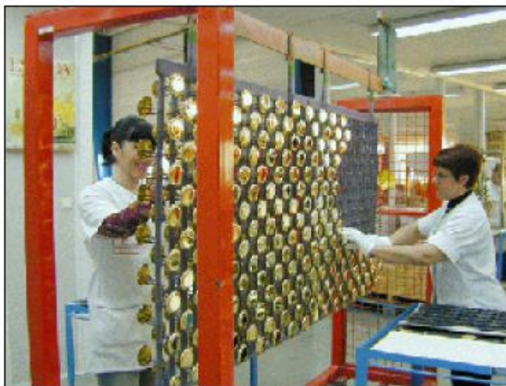
Figure 2.5 : Revêtement avec support de pièces ou montage porte-pièce : déchargement des composants finis
