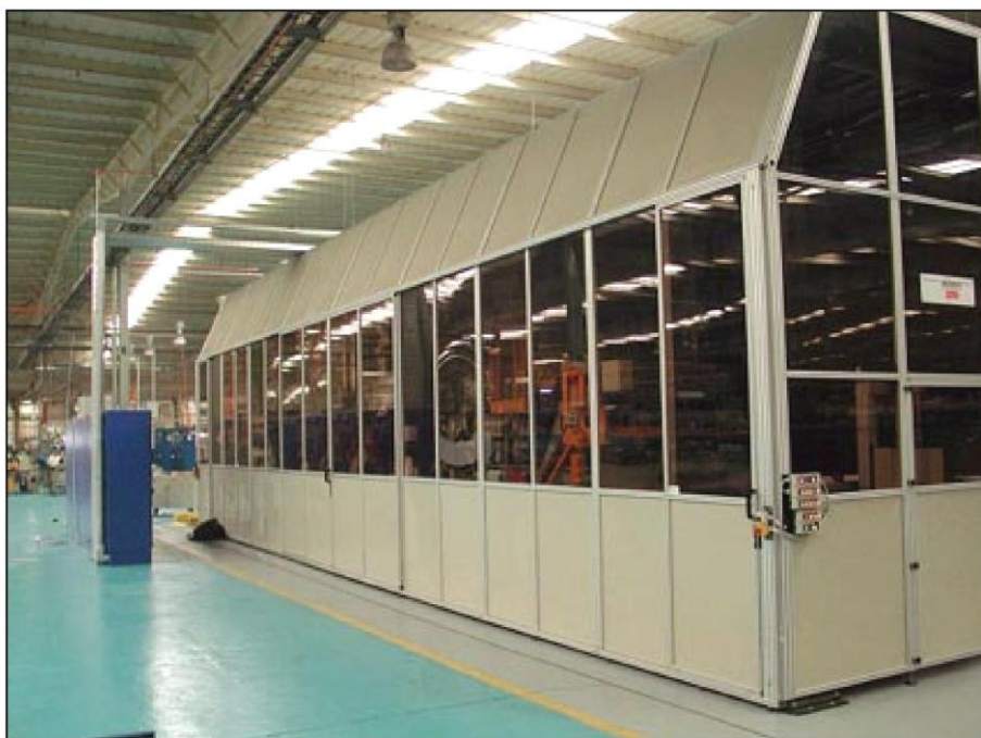
Figure 4.2 Chaîne de chromage intégrée et fermée [140, Atotech, 2003]
