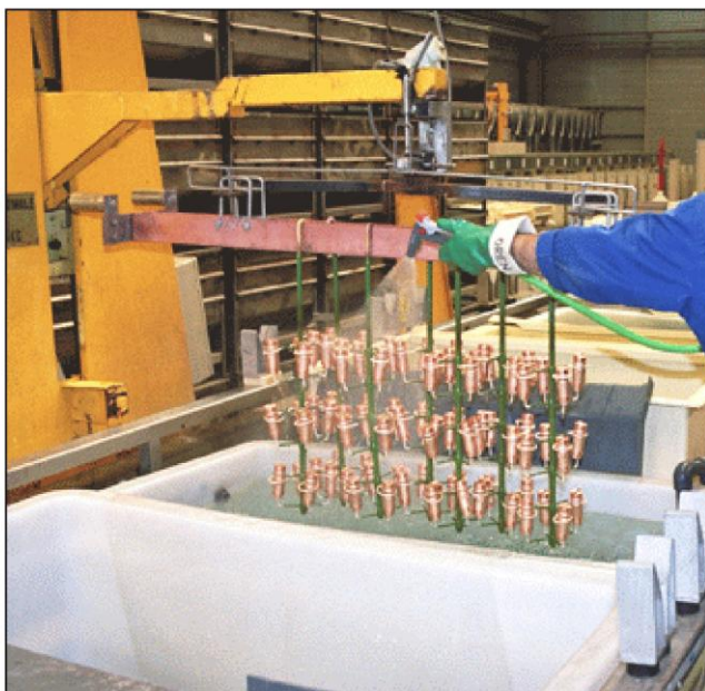
Figure 4.6 Rinçage par pulvérisation manuelle Producmetal S.A., France
