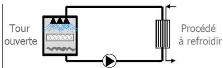
Figure 1: Circuit de refroidissement ouvert (Source MEDD/Climespace)
